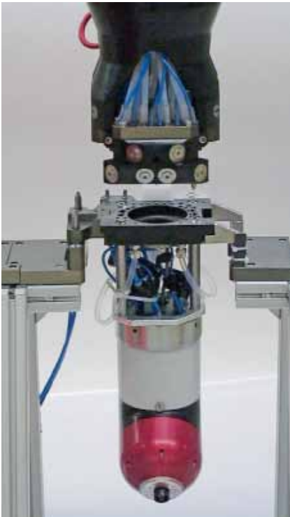
Bild 2: Entnehmen eines Picobell-Zerstäubers aus dem Zerstäuberbahnhof
